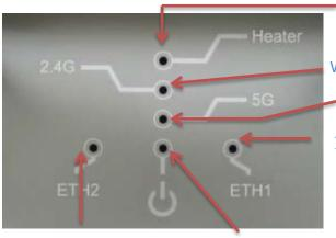
Heater 燈號顯示, 當機板溫度為 0 度時, Heater 更能啟動, 燈號將亮起
