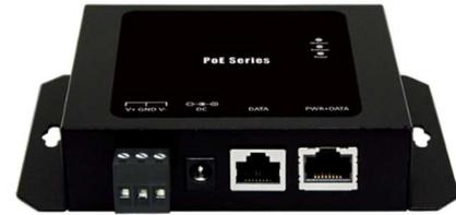
CERIO POE-DX90T 90Watt PoE Injector 寬溫網路電源供應器，支援 5-Speed (100M/1G/2.5G/5G/10G) 乙太網路傳輸能力，最大乙太網路傳輸能力可達 10Gbps。符合 IEEE 802.3bt/at/af 標準規範，是一款主動式 PoE 網路電源供應器。硬體設計包括了 2 個 乙太網路埠，提供了 DC 48-57V 輸入電壓，且支援 DC In 或工規可拔除式供電端子 (Screw Terminal Block) 雙輸入電源接入方式供電。最大 PoE 輸出電力可達 90Watt，可滿足時下與未來超高速 10G 等級與高功耗電力的 PD 網路設備所需。藉由此 POE-DX90T 電源供應器即可透過 RJ45 網路線同時傳送網路資料與電力至 PD 受電網路設備裝置。提供工規等級金屬外殼與寬溫 (-40° ~ 75° C) 硬體設計，不僅堅固耐用、可靠度高，且支援壁掛安裝，充分滿足高規工業環境網路建置的應用需求。
