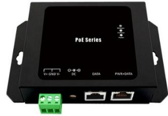
CERIO POE-DGT-ZW DC12-56V Gigabit to 30Watt PoE+ Adapter 寬溫/寬壓網路電源供應輸出器，支援 IEEE 802.3af/at 標準規範，是一款主動式 (Active Type) 可升壓 PoE+ 網路電源供應輸出器。除硬體設計包括了 2 個乙太網路埠外並提供寬範圍輸入電壓 DC 12~56V 的硬體設計，可自動升壓轉換為最佳傳輸效能 802.3af/at 標準 PoE 56V 電源供電給 POE 裝置使用，且最大 PoE 輸出電力可達 30Watt。對於需要配置的環境當受限電壓僅有 12/24/37.5/48V 電力時，可透過工規可拔除式供電端子 (Screw Terminal Block) 輸入自動升壓能力，自動升壓至完成標準的 802.3af/at 56V 的 PoE 的環境應用，此一產品提供了最佳且極具經濟效益的解決方案，是一款多功能且高規的寬溫/自動升壓網路電源供應輸出器。
