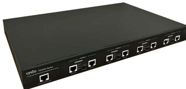
CERIO TD-04AT-S 是一款 PoE PD 負載測試的解決方案，最多可支援 4 個通道，每個通道的最大負載功率可支援 25.5Watt 抽載，完全符合 IEEE 802.3af 和 802.3at 標準規範，且皆支援網路交換機功能，並提供 1/2.5Gbps Multi Gigabit RJ45 乙太網路傳輸能力，可針對 PoE PSE 網路設備進行物理受電負載及封包傳輸測試，除對物理驗證 PoE PSE 網路設備其 PoE 送電承載外，更可依每埠 by Switch 交換埠之特性讀取每埠彼此的封包傳輸能力正常與否，絕對是大型單位驗收 PoE 裝置設備時所需的物理驗證指定工具，包括電力能力極限是否足夠、系統安裝工程師於事前檢測設備以確保安裝順利和降低時間與人力成本、其他故障排除驗證等，也適用對於 PoE 裝置於生產時的驗證等需求，是生產或驗證測試 PSE 網路設備不可或缺的重要工具。
