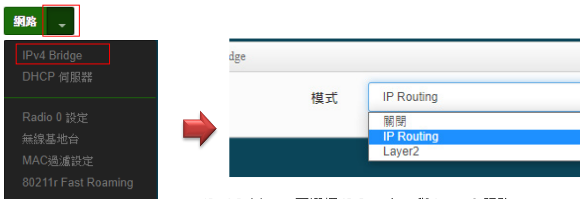
IPv4 Bridge：可選擇 IP Routing 與 Layer2 服務。
