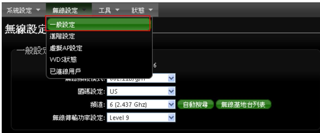
主要能設定「無線運作模式」、「無線傳輸控制」、「區域設定」、「頻道」及「無線傳輸功率」設定
