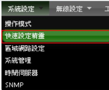
成功登入系統後請進入「快速設定精靈」，然後點選「下一步」，網路管理員可透過此頁面進行操作模式的變更，並依步驟 1. 設定「操作模式」2.設定「區域網路」連線 3.設定「無線網路」4.設定「無線加密功能」逐步下一步設定後最後請按下「完成」&「重新啟動」鍵重新啟動系統。請在快速設定精靈頁面，請點選「下一步」開始設定。
