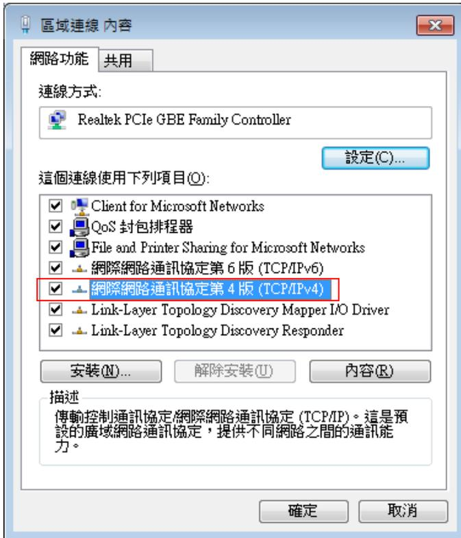
**步驟 6:** 點擊 TCP/IPv4 將進入 PC 或筆電的 IP 位址設定頁面，預設為自動取得 IP 位址，我們將它改為 ” 使用以下的 IP 位址 ”，並在 IP 欄位打入與 100GX-N 同網段 IP 位址，例如 100GX-N 的預設 IP 為 192.168.2.254，則 PC 或筆電的 IP 為者可以設定 192.168.2.x，x 可設定 1~至 253 之間的數值。以下圖為例，完成設定，接下來參考 [2.2 登入 100GX-N 的 WEB 管理頁面](#)。
