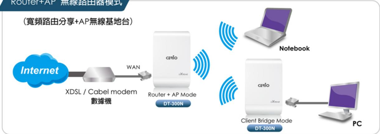
若您的無線環境過大需要延伸無線訊號，啟動 Router AP 模式下的 WDS 功能主要除了可以增加無線網路本身的訊號範圍，DT-300N v2 能以單點對單點的模式連結外也可以選擇以多點對多點的方式進行 WDS 連結，DT-300N v2 會將上層網路的資料直接傳送至下端網路或使用者，提供網路傳輸、資料傳送以及其他的網路應用，當運作為 WDS 模式時通常是以無線的方式進行骨幹網路建置，但 DT-300N v2 可同時提供有線或無線的方式供下端網路連結。
