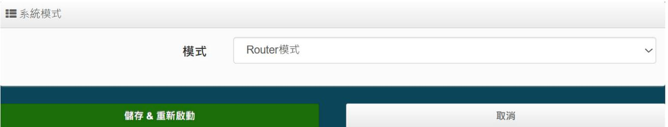
當您啟動了 Router AP 模式後，WAN 埠連接上端 ISP 的 DSL 裝置，例如：PPPoE ADSL / Cable Modem / 固定制 ADSL 等，同時設備自動啟動 NAT 與 DHCP 功能以提供下層有線或無線使用者連結，並內建相當進階的功能，使用者可以依照需求進行網路連線管制、DMZ 以及虛擬伺服器規則設定等。
