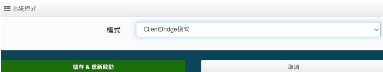
切換此模式，WAN 端撥接方式將使用 Wireless 方式與上端無線 xDSL 做橋接。WISP 模式是 (Wireless Internet Service Provide)的簡稱，WISP 的 WAN 端是以無線方式橋接 xDSL 基地台，連線方式支援動態 IP、靜態 IP、PPPoE 及 PPTP 等。
