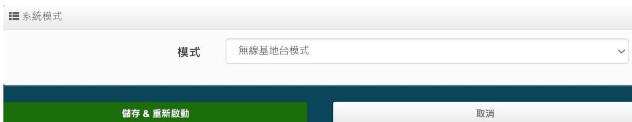
當環境已完成建置有線上網服務後，若想利用無線方式進行上網，可將設備轉換為無線基地台模式，只需將網路線連接至設備並設定好無線基地台相關設定，即可達成使用無線上網之應用。
