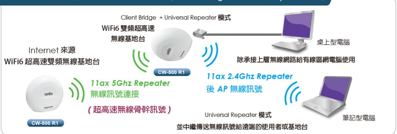
Repeater AP 功能，則表示當 Client Bridge 確實與上端 AP 做連接後，自己本身可在建置出無線基地台，即為訊號再延生產生無線基地台訊號機制。
